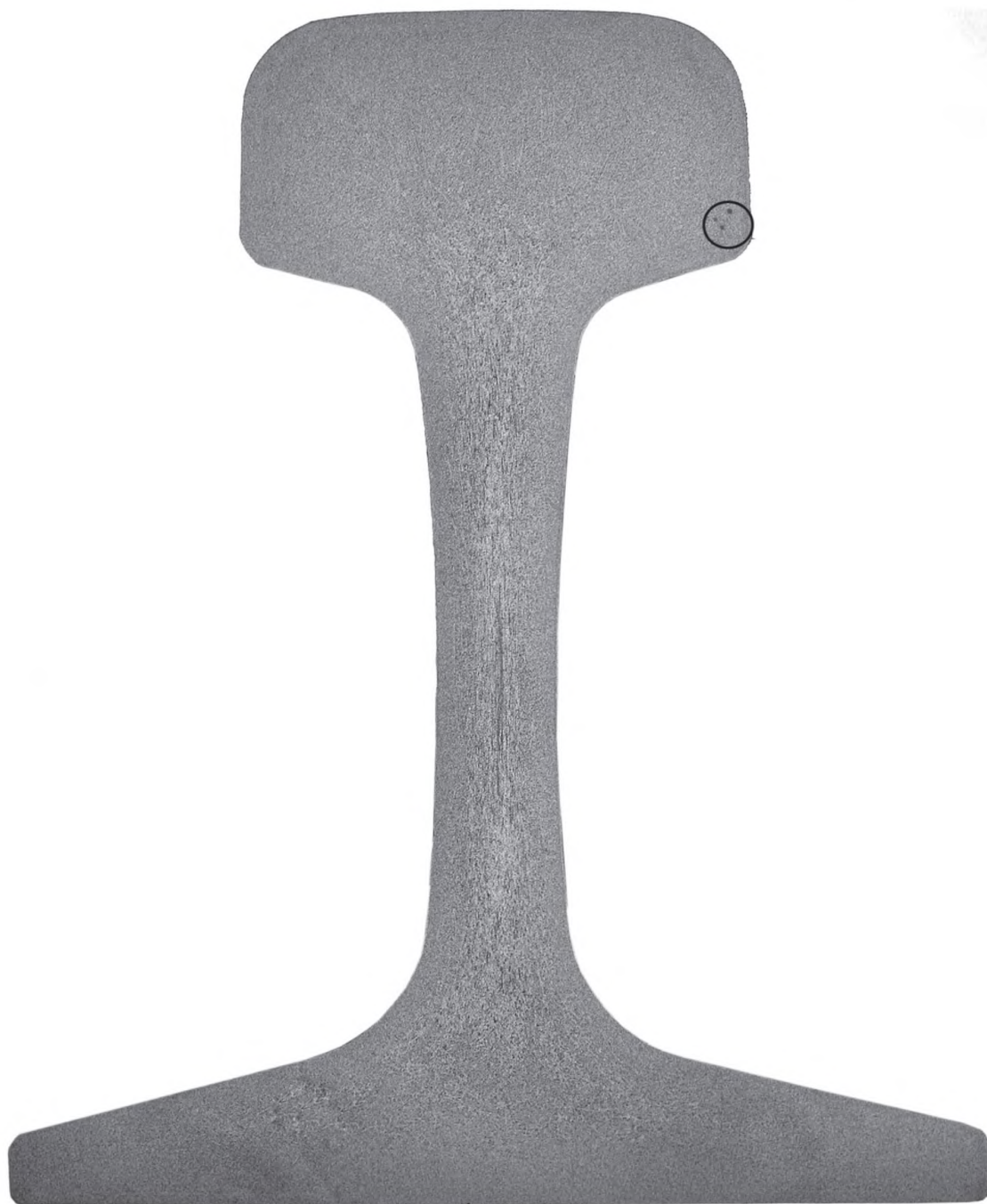
Рисунок И.12 — Скопление точек любого диаметра (глубокое травление)
